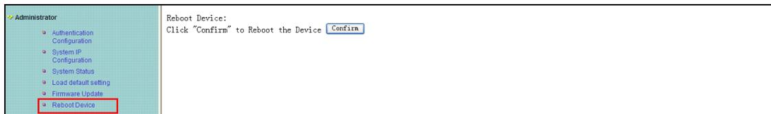
图为交换机热重启控制界面。在页面中，当修改系统 MAC 地址等需要重启的设置后，建议重新启动设备来使设置生效。
