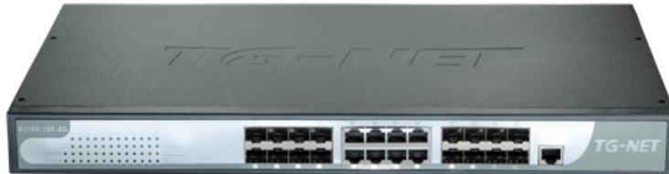
图1.1.3 S3100-16F-8G以太网交换机前面板示意图
